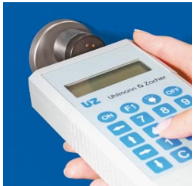
Auslesen eines Zylinders mit dem CX6510 Service-Gerät
