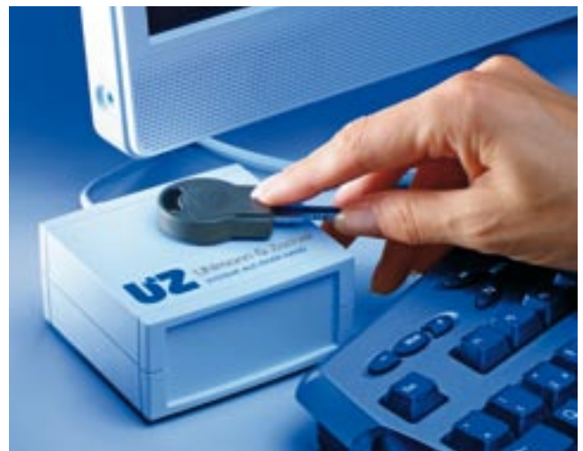
Programmieren eines Schlüssels an der Programmierstation
